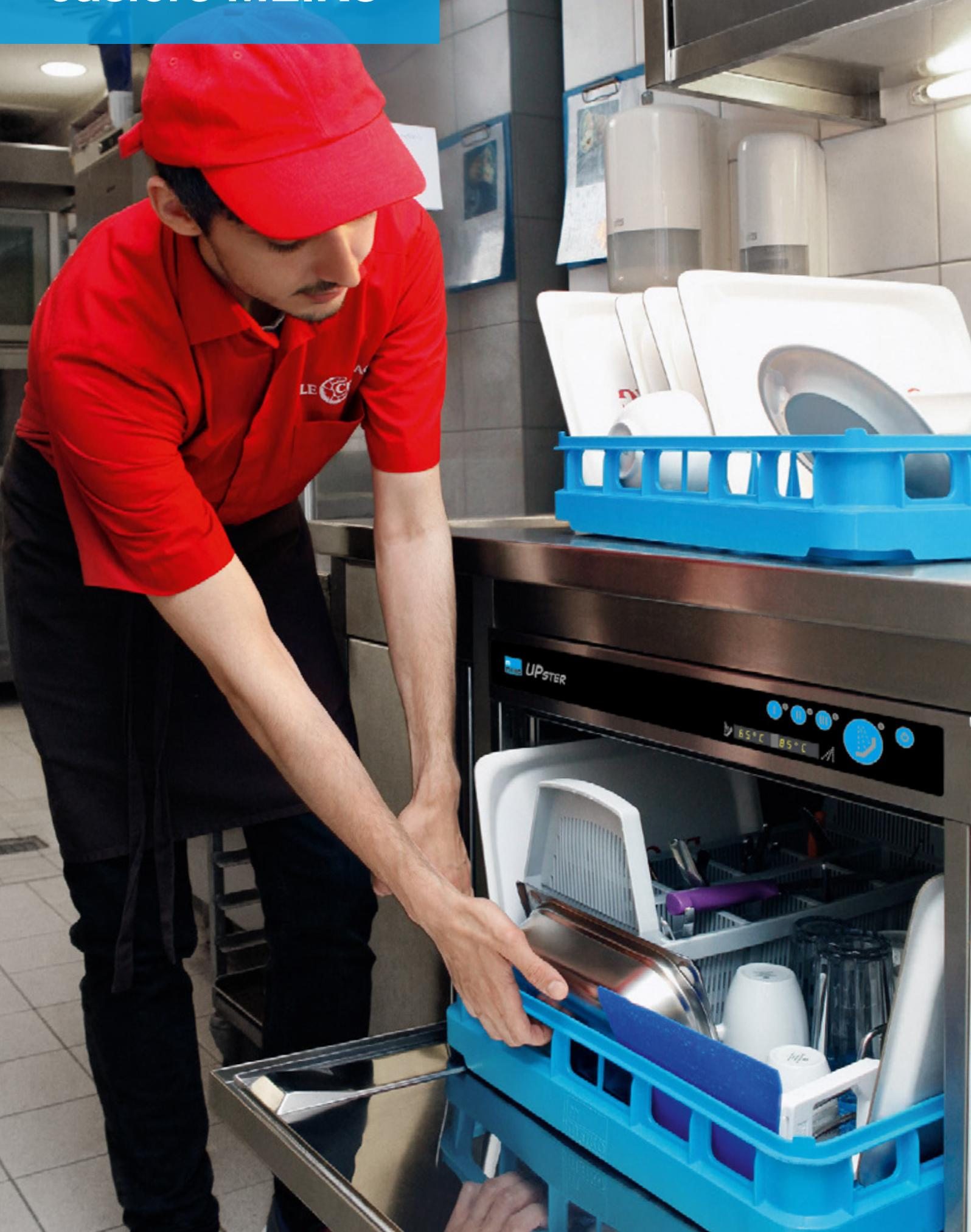
Du casier universel pour les assiettes, tasses et sous-tasses, aux casiers à verres ou à plateaux, en passant par le panier à couverts, MEIKO propose une multitude de casiers pour tous les types de vaisselle. Les modèles plastiques sont en polypropylène et donc extrêmement robustes. Le concept ouvert des casiers évite l'effet parapluie et favorise le passage de l'eau.
